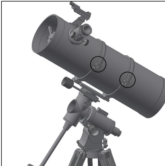
Fig. 9. Colocación del tubo y las arandelas.
