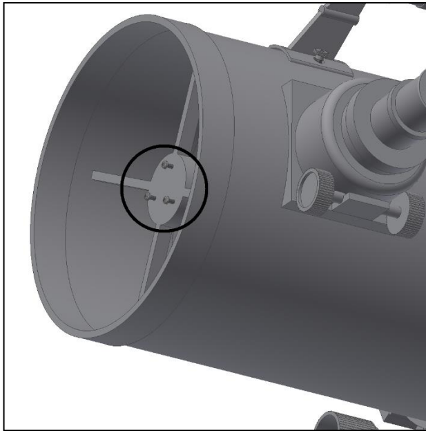
Fig. 17. Ajustar el espejo diagonal.
