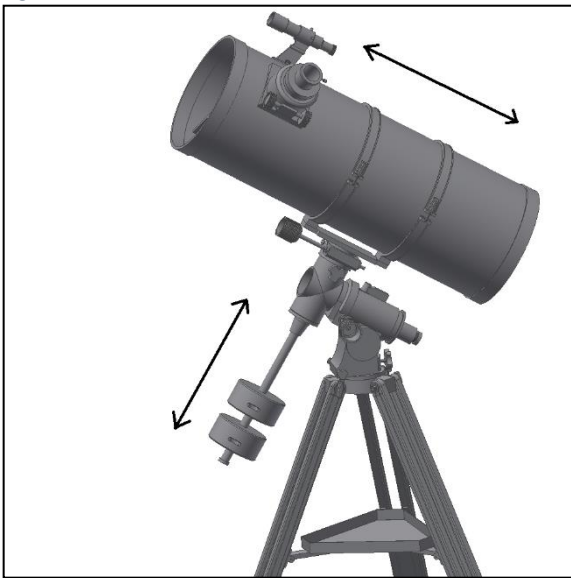
Fig. 14. Equilibrado del telescopio.
