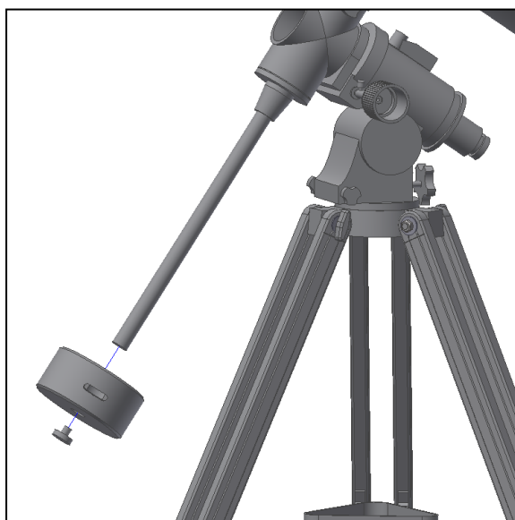
Fig. 6. Colocación del contrapeso y el tornillo de cierre.
