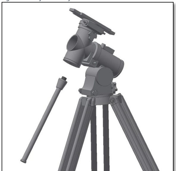
Fig. 5. Montaje de la vara de contrapeso.
