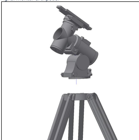
Fig. 4. Montaje de la montura ecuatorial.
